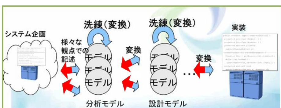
変換を適用する前後のモデルが共存してそれぞれ発展する。あるモデルに加えた**変更**を正しく、自動的に他のモデルに**伝播**し、システムの一貫性を保証。人手による逆変換の個別対応を排除することで高信頼化・生産性向上を実現する。本研究ではモデルをツリー等ではなく**グラフ**として表現しており、より**柔軟なモデル**を扱える。
