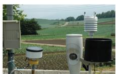
中央農業総合研究センターが開発したフィールドサーバを農地に設置して、ネット経由でリアルタイムモニタリングする。写真は群馬県嬬恋村のキャベツ畑。
