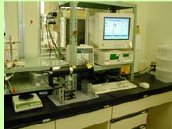
パーティクルカウンタによるダスト分析
