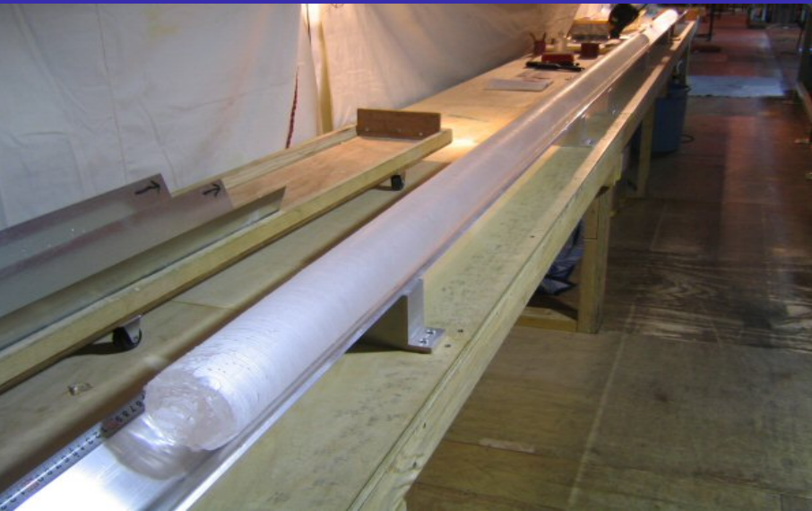
1回の掘削で得られる長さ3.8mの氷床コア
