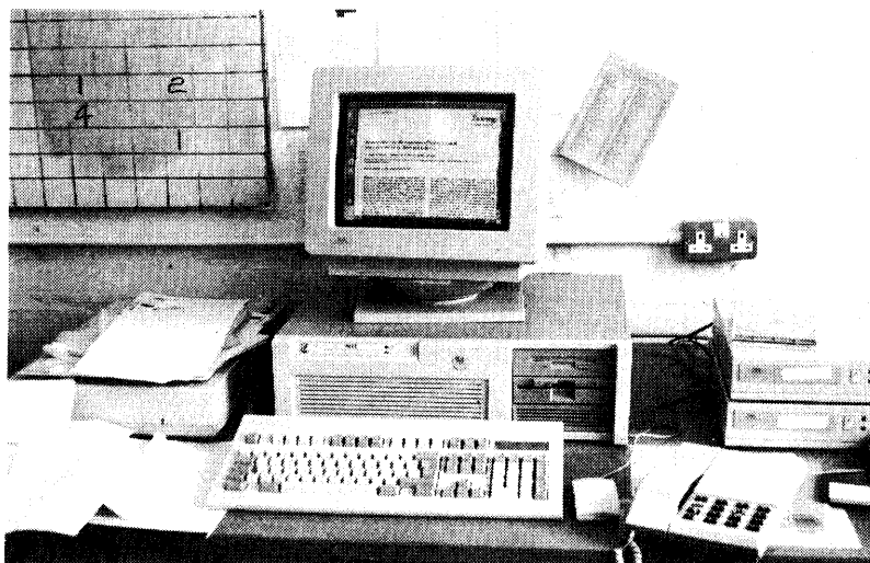
ADONIS システム。オンラインの CD-ROM による文献配布。 画面には雑誌のページイメージが出ている。CD-ROM は右側。
