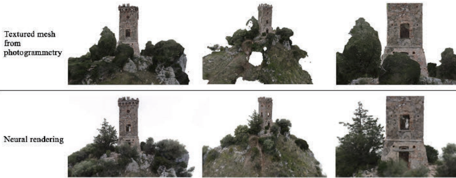
(図3) 自由視点合成技術を用いたデジタルアーカイブの事例 (引用: https://isprs-archives.copernicus.org/articles/XLVIII-M-2-2023/453/2023/ ) ナーフに基づく自由視点合成(下例)は点群ベースのフォトグラメトリ(上例)では困難な樹木などの複雑な形状に対して特に有効であるといわれている。
