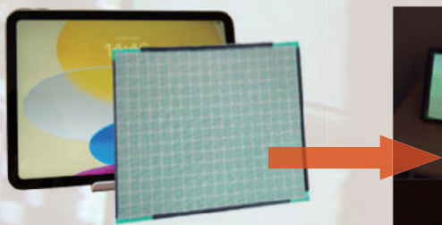
ピンホールアレイ(簡易立体ディスプレイ)小型プロトタイプデモ:回路基盤をピンホールとして流用し、タブレットへ装着、光線場を再現。水平、垂直の視差に対応。映像はピンホールを通り、板上に立体的にディスプレイされる(右図)
