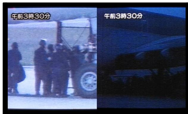
超高感度HARPカメラ CCDカメラ
