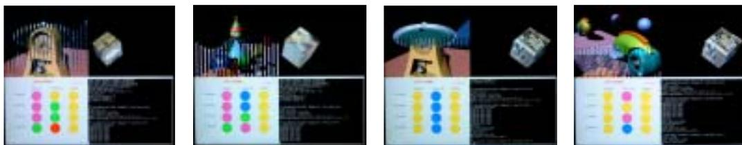
図 3.2.2-3 マイグレーションの実行経過： 四分割左下のモニタ画面の列はアプリケーションを示し（右上、左上の2つが実行中）、行が4台のマシン、各丸の色は負荷を表す。最初の写真は4番目のマシンの負荷が過剰であることを示している。負荷が不均等なのでマイグレーションを行い、2番目の写真のような定常状態になる。そこで右上のアプリを停止すると、各マシンすべてが2個の仕事ずつの定常状態（3番目の写真）にさらに移行する。2番目のマシンに停止命令を出すとその上で動いていた仕事が他のマシンに移動して、アプリケーションは停止しない。
