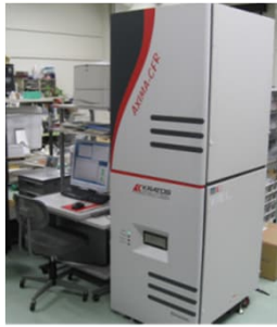
マトリックス支援レーザー脱離 イオン化飛行時間型質量分析計
