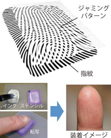
光を反射する薄い素材で作られたジャミングパターンを指先に貼り付けることによって、接触式の指紋センサーには正しく反応しつつ、撮影された写真から指紋を復元できないようにします。
