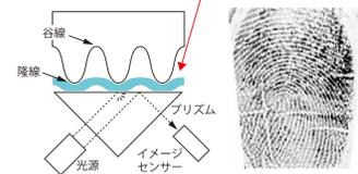
光源からの光はプリズムと空気層の境界で全反射するので、谷線で輝度が高くなる。ジャミングパターンの素材は主に隆線上でプリズムに密着するので、隆線と谷線の識別に影響しない。
