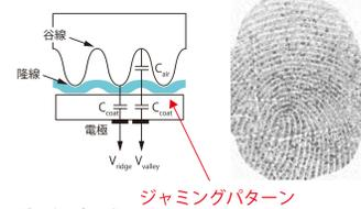
皮膚と電極間の距離に応じて異なる静電容量をピクセルの輝度に変換する。ジャミングパターンの素材は全体の距離を広げるだけなので、隆線と谷線の識別に影響しない。
