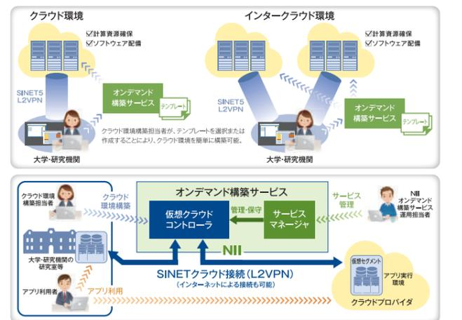
SINETクラウド接続:SINETに商用クラウドを直結し、加入機関に接続環境を提供。商用クラウドサービスを高速・安全・低価格に活用することができるSINETのサービスです。
