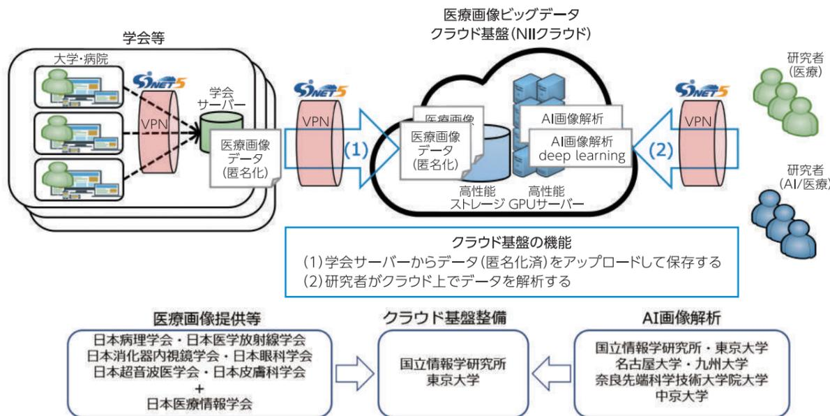
図:クラウド基盤の概要。医療機関や大学などが、学術情報ネットワーク「SINET5」の高性能仮想ネットワーク(VPN:Virtual Private Network)を介して、このクラウド基盤を利活用する。
