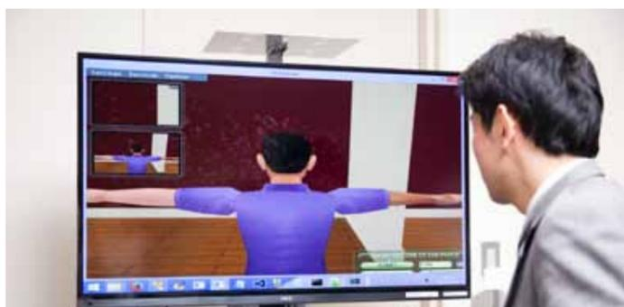
稲邑准教授が、東北大学の出江紳一教授らと開発したシステム。没入型のヘッドマウントディスプレイをつけて、残っている側の腕を動かすと、欠損した側にもCGの手が出て動く。
