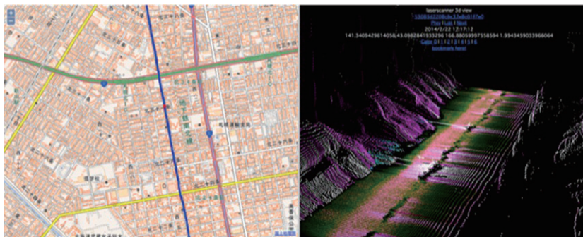
図2 | 中央バス車両搭載レーザーレンジスキャナーによる道路周辺の3次元画像取得
