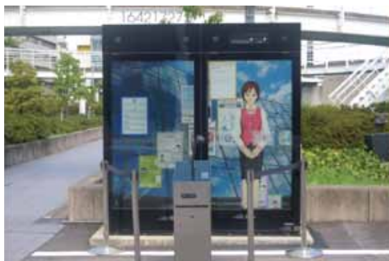
写真1: 名古屋工業大学のキャンパスナビゲーション用に作られたデジタルサイネージ。音声認識 / 音声合成 / CGシステムを搭載し、CGキャラクターが、訪問者と音声でインタラクティブに会話する。このシステムに使われた音声合成システム「HTS」と音声認識エンジン「Julius」は、「MMDAgent」という名前でオープンソースソフトウェアとして公開されている。
