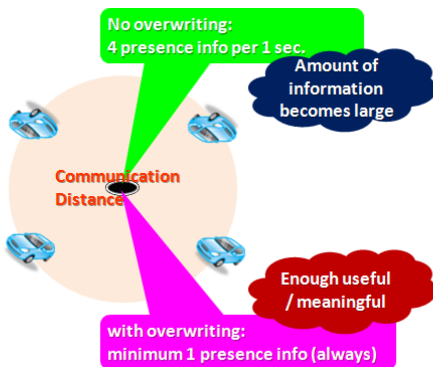
図 6.11 RFID の通信範囲と書き込まれる車両存在情報の量
