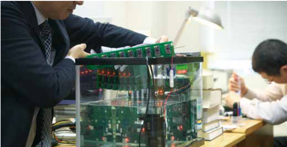
水没コンピュータと故障診断用の試験片を水に沈める冷却試験の様子。
