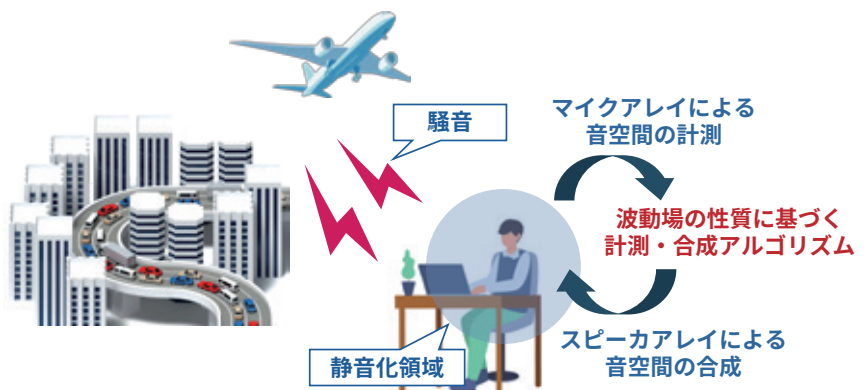
図: 音空間の計測と合成による空間能動騒音制御
